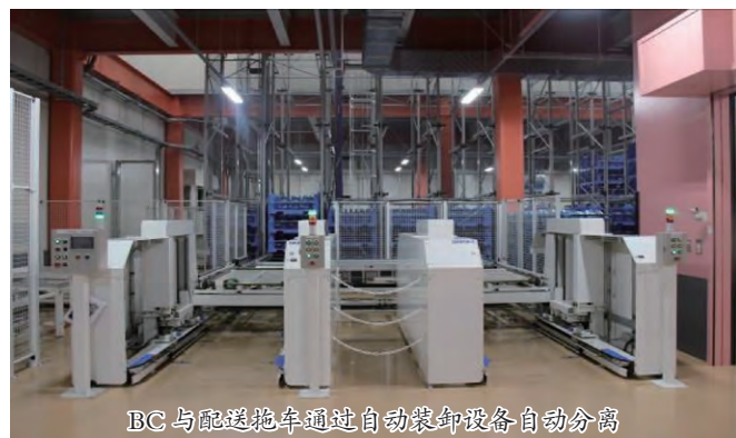
从本庄工厂的配送店铺回收的空桶以 BC 的形式放在配送拖车“dolly”上直接进入入库线
