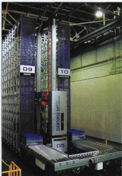
照片1 世界最快的走行速度500m/min, 每小时500箱的超高效能巷道堆垛机‘H-V1’。
