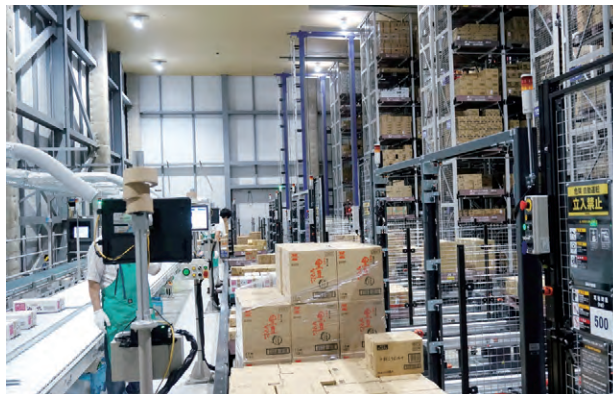
加工食品托盘式立体仓库整箱拣选出库（图左侧的白色圆筒为冷气出风口，为工作区域降温）
