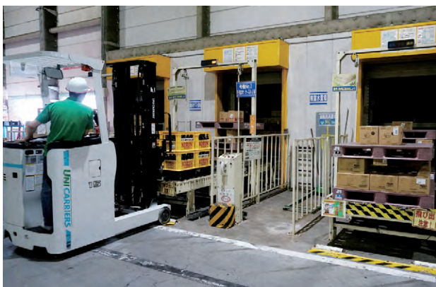
① 托盘货物经垂直输送机送到三层
