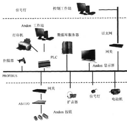
图3 Andon 系统网络示意图
